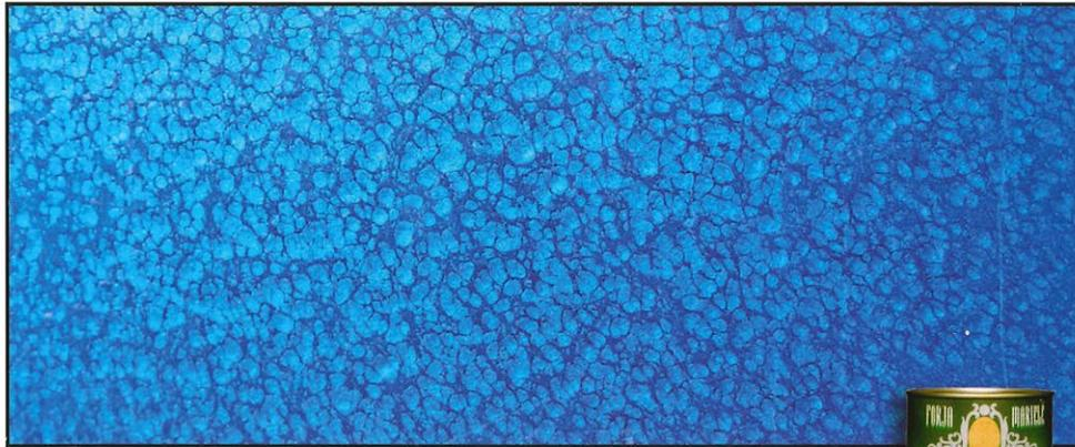
**Martelé:** Esmalte especial para hierro, con acabado martelé. Este acabado decorativo se recomienda para "disimular" las modificaciones causadas por el óxido además de las imperfecciones del metal. Adecuado en barandillas, rejas, puertas de ascensor, etc.
